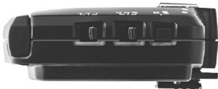
**3.** Для каждой из задействованных ведомых групп задайте ручной (M) или автоматический (A) режим работы при помощи переключателей модуля АС3. Посредством поворотных дисков задайте для групп настройки мощности (черные цифры на белом фоне обозначают увеличение мощности на соответствующее число ступеней, белые цифры на черном фоне обозначают уменьшение мощности на соответствующее число ступеней).
